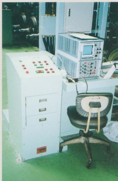
■操作盤及び探傷器
